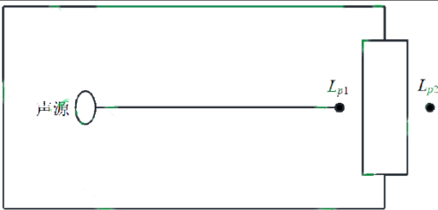
图 4.2-1 室内声源等效为室外声源图例
